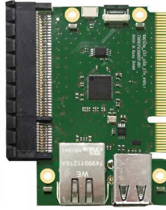
SBCSOM Erweiterung: USB Hub + 100Mbit Ethernet
